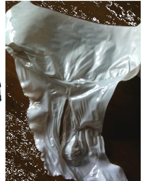
Déformation-rupture d'un sac PE
